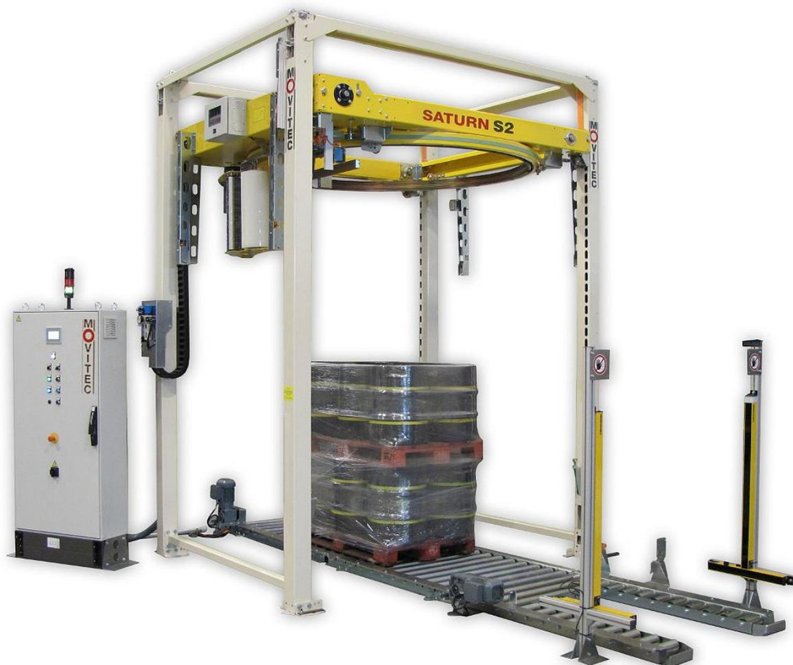
Сатурн С2 полностью автоматический обмотчик в стретч для паллет с продуктом. Рулон с пленкой помещается на вращающейся каретке. Каретка движется вниз и вверх, оборачивая пленку вокруг паллеты таким образом, что паллета остается неподвижной. Мувитек разработал Сатурн С2 для низкопроизводительных производств (до 45 паллет в час)
