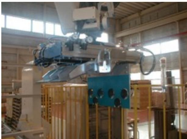
Захваты для коробов бывают самых разнообразных форм и размеров. В зависимости от продукта и необходимой производительности захват может за один раз укладывать одну или несколько коробок. Также может дополняться крюками для паллет и устройством для укладки картонных листов.
