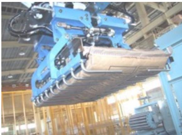
Захваты на робот паллетайзер устанавливаются исходя из того, какой продукт требуется укладывать на поддон. Захваты для мешков могут быть различных размеров и проектируются индивидуально под каждую линию укладки.
